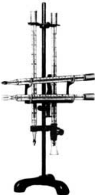
Σχ. 2.3.1 Το ψυχρόμετρο August μαζί με δύο ακροβάδια θερμομέτρα.
